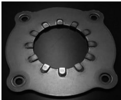
写真2 UL プレスによる成形品（フランジ）
