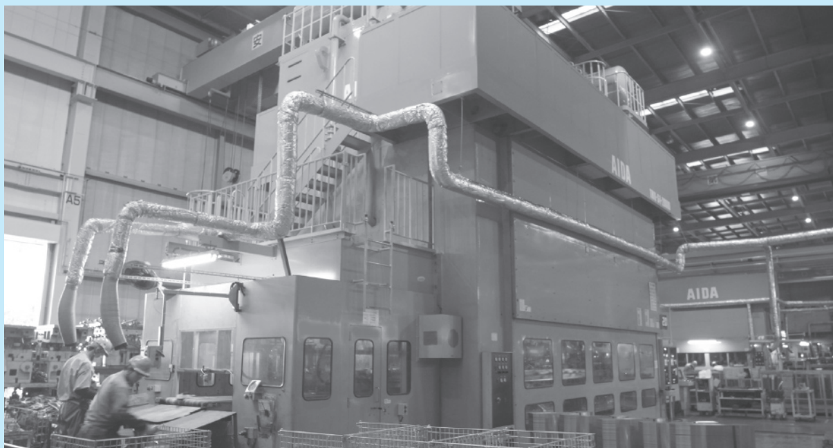
▲ 3次元トランスファープレス TMX-2000トン（吉備工場）
