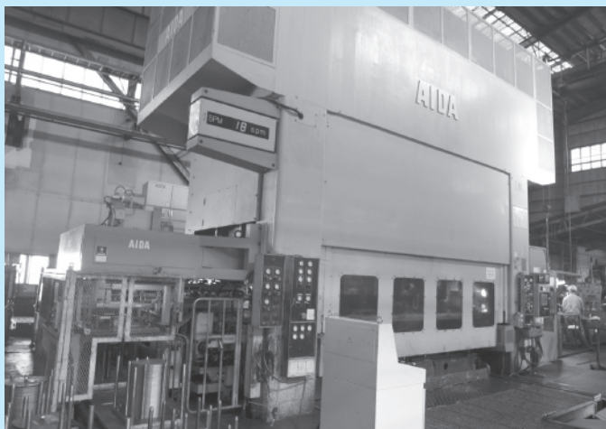
▲トランスファプレス500トン(笠岡)の送り装置をサーボ化し工程の近代化をはかる
