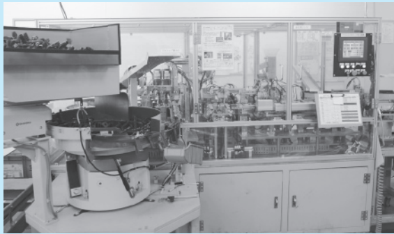
▲ 自動溶接組立て装置
