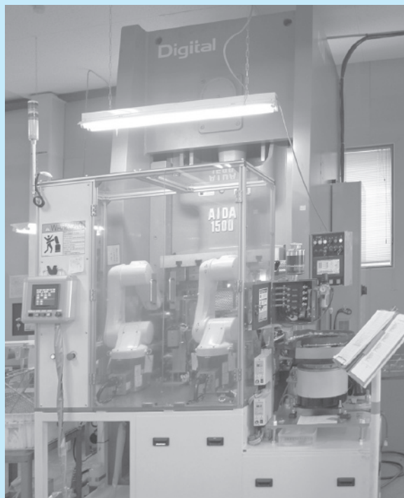
▲ ダイレクトサーボフォーマ NS1-150トンと独自開発による自動化成型加工装置
