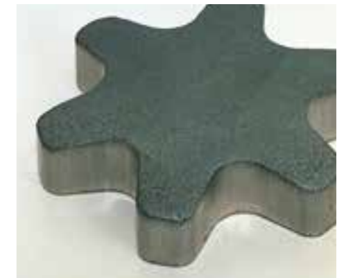
極厚板加工 Ultra Thick Plate Blanking t : 10mm (SS400)
