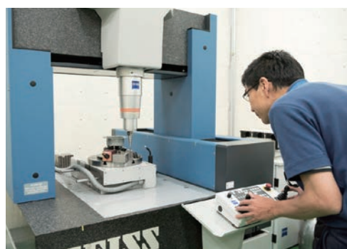
3次元測定器での測定作業
