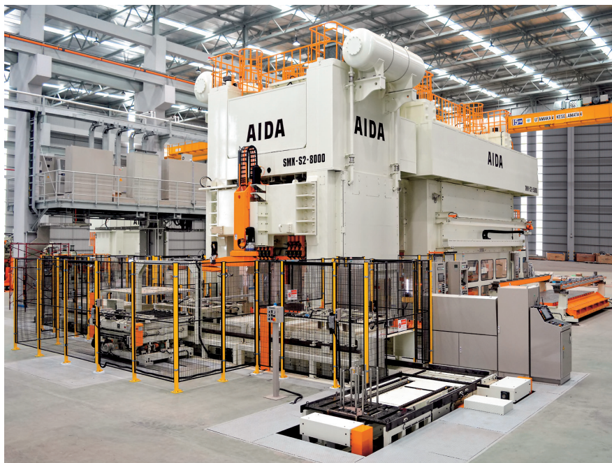
「第62回十大新製品賞（モノづくり賞）」を受賞したハイテン材対応の高速トランスファープレスライン
