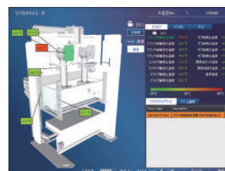
異常発生箇所を3Dで表示して見える化するSCADA機能も搭載
