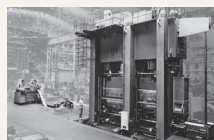
世界最大級(当時の)2,500トン トランスファープレス
