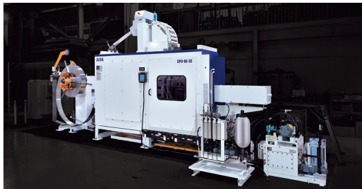
新開発した角形電池ケース成形専用機DPH-80-30
