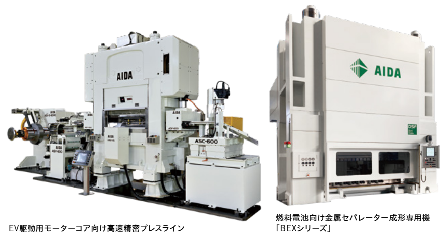
EV駆動用モーターコア向け高速精密プレスライン
