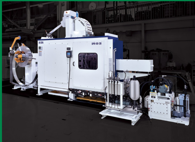
新開発した角形蓄電池ケース成形専用機DPH-80-30
