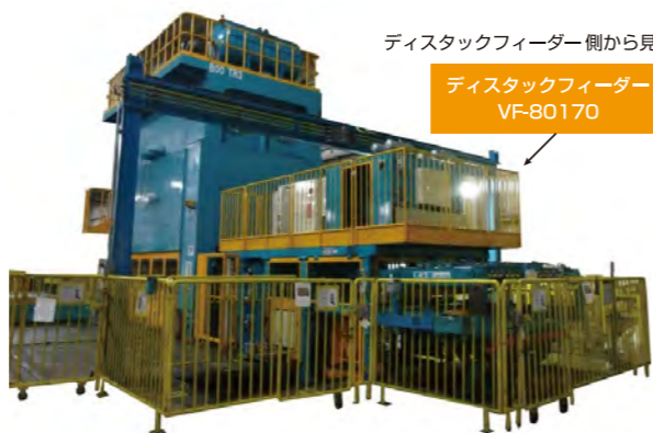
中間搬送方式：グリップフィーダー、コンベヤー & シャトル式 ディスタック装置：サーボ昇降式
