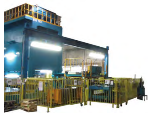
中間搬送方式：マグネットコンベヤー式 ディスタック装置：エアシリンダー昇降式
