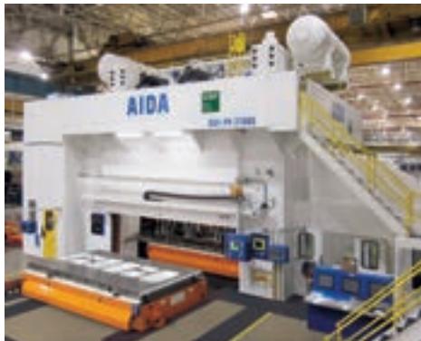
「十大新製品賞」を受賞した 大型サーボプログレッシブプレスDSF-P4-27000
