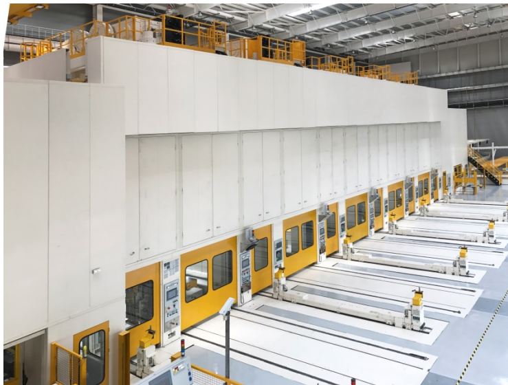
※FMC 納入ラインと同等タイプのサーボタンデムライン
