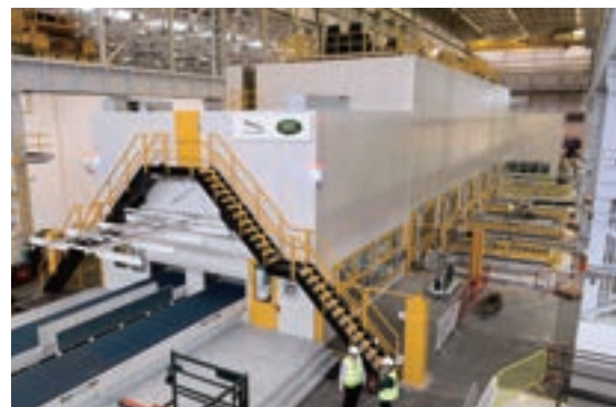
ヘイルウッド工場にて稼働中の自動車ボディーパネル等成形用大型サーボプレスライン
