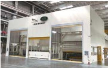
英国・中国大手自動車メーカーの合併工場に納入したアイダ独自のアルミ成形用ディスクスタックフィーダー付大型サーボタンDEMライン
