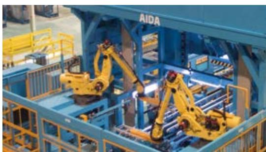
ブランク材を1枚ずつ分離し、高速でプレス機械に連続自動供給する自動機、ディスタックフィーダー
