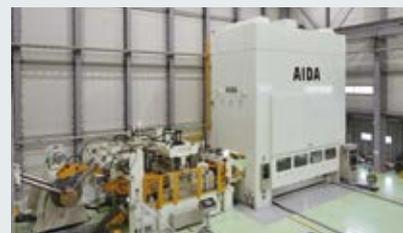
金型の大型化や自動車部品の高ハイテン化に対応するPMX-L2-16000
