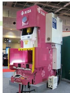
レトロフィット工事の例（メカ式プレスのサーボ化）
