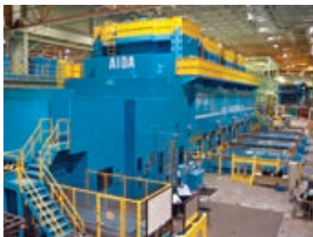
当社が納入した高速サーボタンデムライン事例
