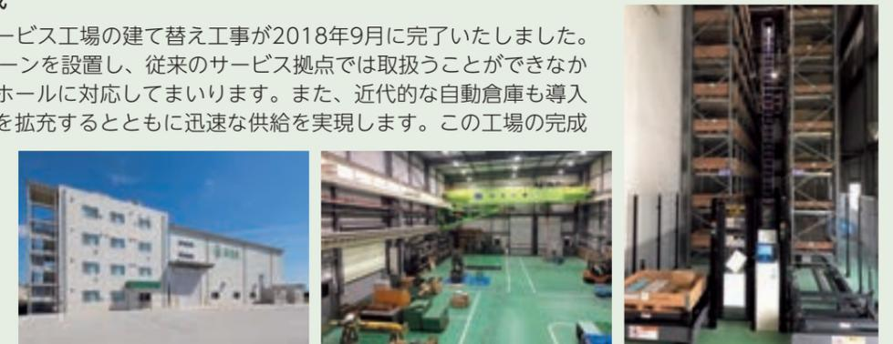
延床面積は旧工場の2.3倍に拡張 50トン大型クレーン/ウォールクレーン コンピュータ制御による自動倉庫
