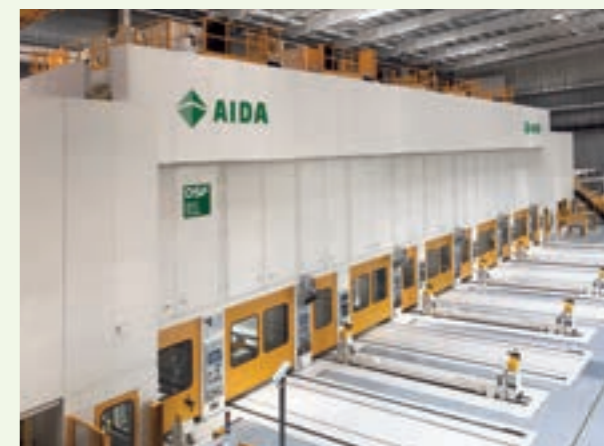
2019年3月稼働開始予定のFMC納入ラインと同等タイプのサーボタンデムライン (イメージ)
