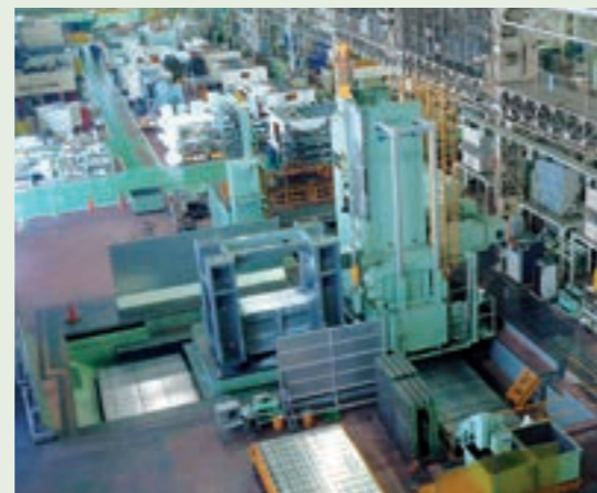
日本、イタリア、アメリカの各生産拠点に導入される大型横中ぐり盤 (写真は本社工場)
