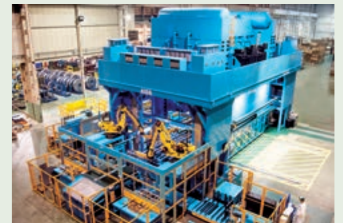
大型サーボトランスファープレスDSF-T4シリーズ (加圧能力3,000トン)
